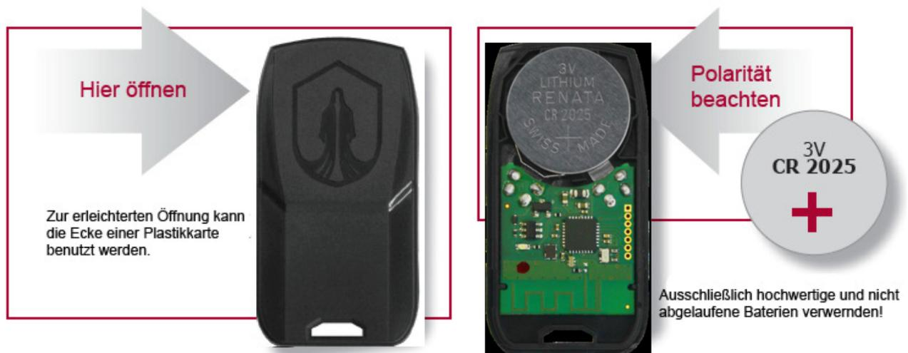
*Bei Umgebungstemperaturen unter null Grad können Batterien auf Grund einer langsameren chemischen Reaktion schwächer sein. Es kann die Identifikation des TEC-BT Tags erschweren, besonders wenn dieser solchen Temperaturen über einen längeren Zeitraum ausgesetzt wurde. Um die Leistung zu verbessern reicht es dann aus den TEC-BT zu erwärmen.*
